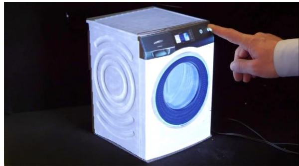
Abb. 5: Interaktive Bedienung der Waschmaschine über im 3D-Druck verbaute Touch-Sensoren
