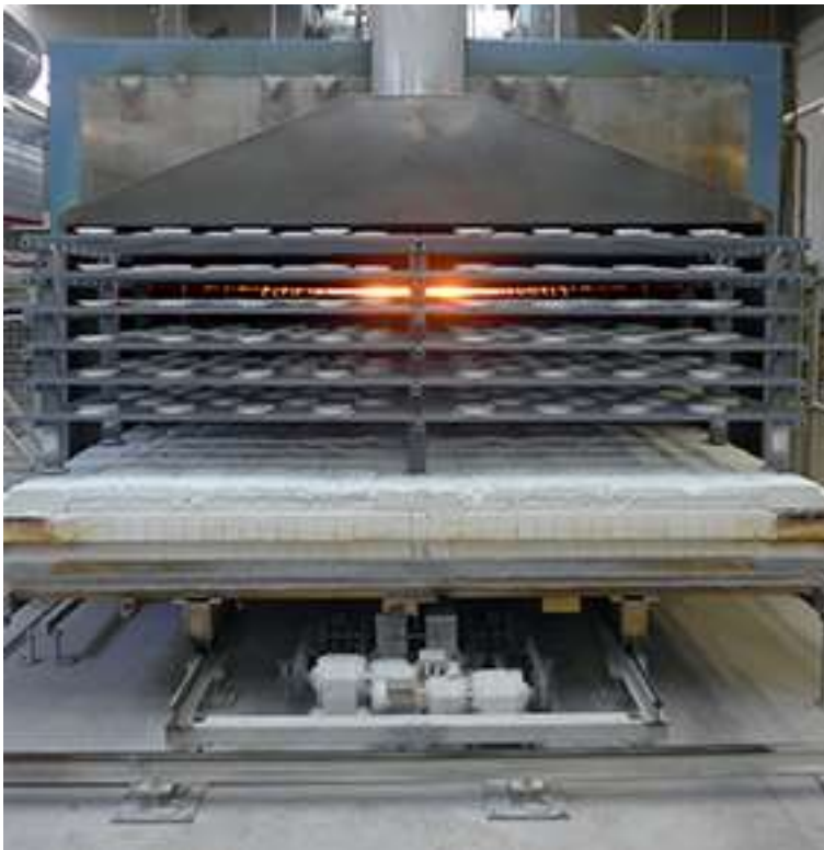
Abb. 2: Industrieofen mit Brenngut (Foto: Rosenthal)
