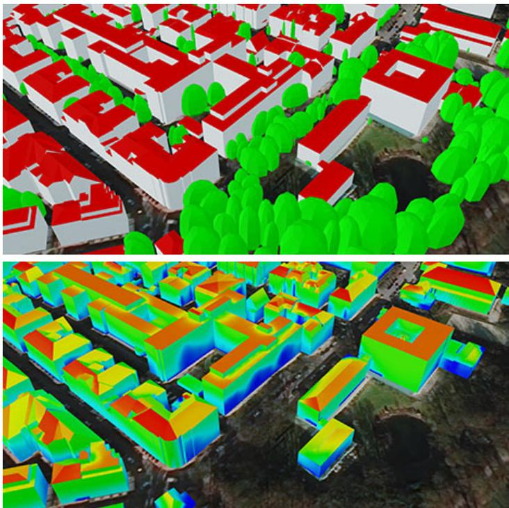
Kleinräumige Solarpotenzialanalysen berücksichtigen nicht nur die Gebäude und ihre Flächen, sondern beziehen auch die unmittelbare Umgebung der Gebäude in die Modellierung mit ein. Hier wird deutlich, welchen Einfluss der Baumbestand und der damit verbundene Schattenwurf auf die solare Einstrahlung haben. Blau steht für wenig, rot für viel Einstrahlung.
