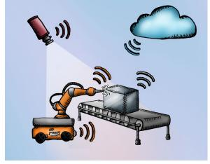
Projekt »fast robotics«. Nahezu sämtliche Kommunikation zwischen Roboter, ambienten Sensoren, Bauteil und Steuerungstechnik erfolgt mit Hilfe der neuen Lösung kabellos, dezentral und in Echtzeit über Cloud-Lösungen.
