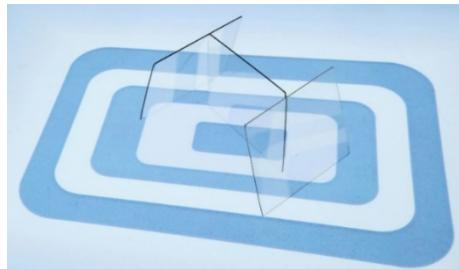
Transparente Keramik (hier: Spinellkeramik) kann zum Beispiel für hochbeanspruchte Displays von mobilen Endgeräten eingesetzt werden. (Foto: Fraunhofer IKTS)
