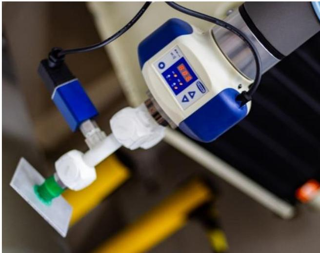
**Einer der Demonstratoren der KI-Schulung: Ein Sauggreifer saugt Plättchen verschiedenen Materials an und misst präzise den Druckverlauf. Anhand der Messdaten gilt es, verschiedene Materialien zu unterscheiden und zu sortieren.**
