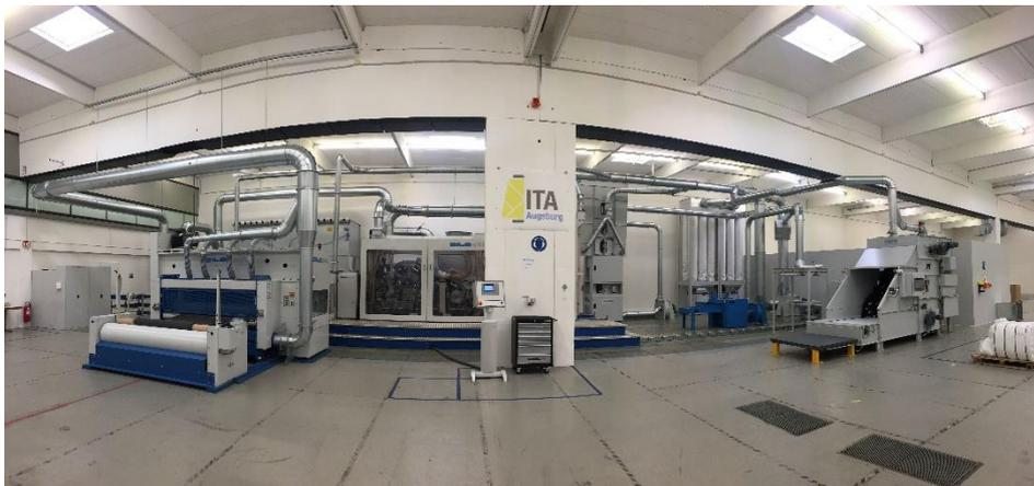
Vliesstoff-Kompaktanlage (DILO) zur Herstellung von Nadel-Vliesen aus Sonderfasern.
