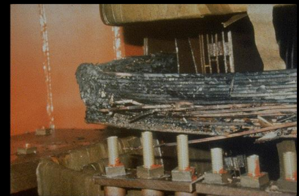
Zerstörter Transformator in New Jersey, März 1989.
