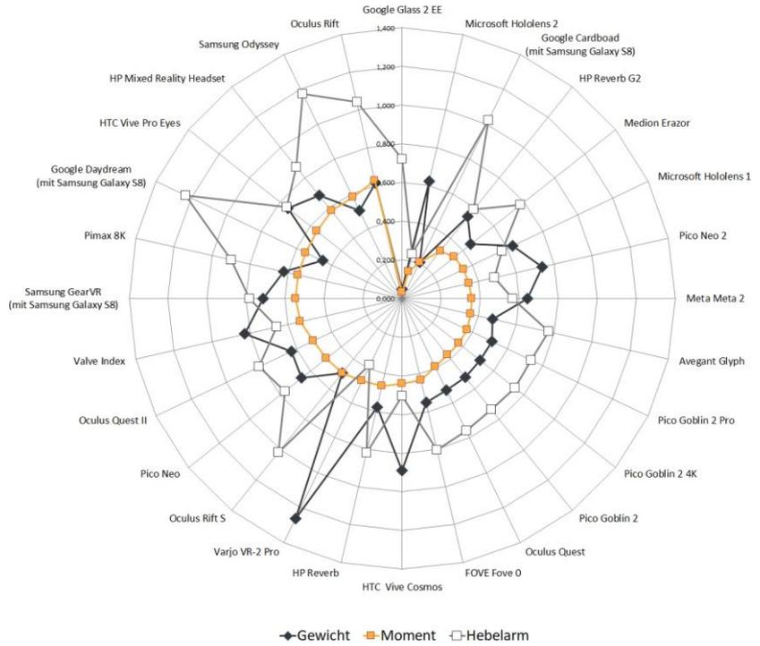
Abbildung 2: Gewichte und Drehmomente in Relation zum Hebelarm (Quelle: VDC)
