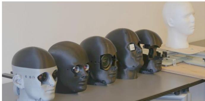
zu den Refresh-Raten zutreffend waren – **Abbildung 1: Messaufbau: 3D-gedruckte Köpfe mit Kameras (Quelle: VDC)** abgesehen von geringen Abweichungen bei den Pico-Systemen und der Pimax 8K KE. Weiterhin konnte bei keinem der getesteten HMDs Ghosting festgestellt werden.
