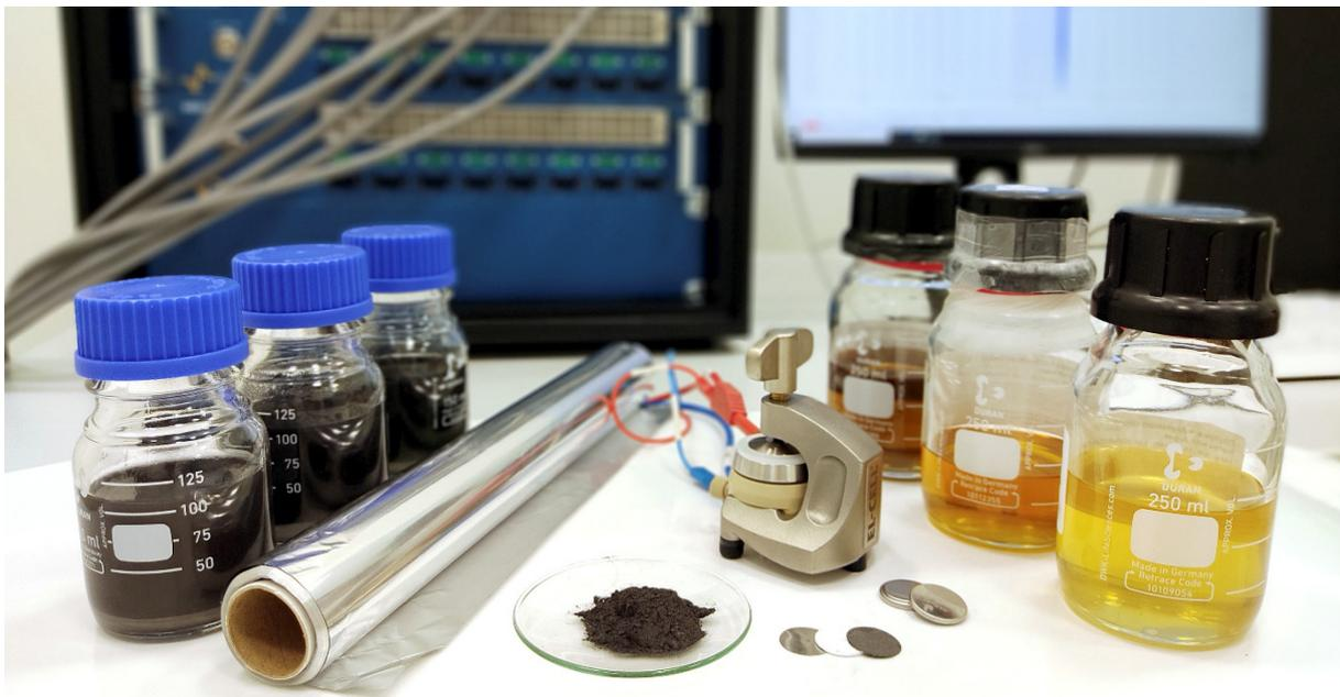
*Die wichtigsten Komponenten einer Aluminium-Ionen-Batterie: Graphitpulver, Aluminium-Folie und ein spezieller Elektrolyt, der aus einer bei Raumtemperatur flüssigen Salzschnmelze besteht. Bild: Maximilian Wassner / Fraunhofer THM*
