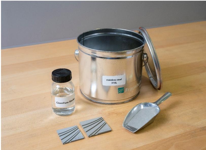
CleanFuse Bindemittel, Stainless-Steel-Metallpulver und in 3D-Druck hergestellte Teile vor (rechts) und nach (links) dem Sintern. © Fraunhofer IFAM
