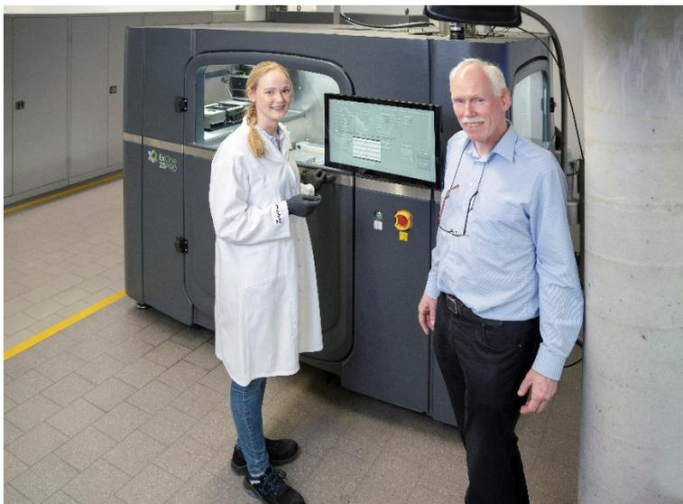
Mit dem neuen X1 25Pro von ExOne wollen Prof. Frank Petzoldt und sein Team die Pilot- und Vorserienproduktion von Bauteilen mittels Metal Binder Jetting untersuchen. © Fraunhofer IFAM
