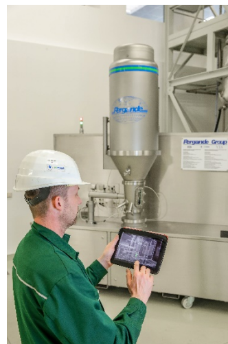
Der intelligente Digitale Zwilling des Projekts TwinGuide wird beispielhaft an einer Wirbelschichtanlage für Sprühgranulation beim Anwendungspartner Pergande Group erprobt. Foto: Fraunhofer IFF
