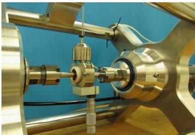
Mit dem neu entwickelten In situ-Tribometer lassen sich direkt im Betrieb Verschleiß und Reibwerte von Gleitlagern messen.
