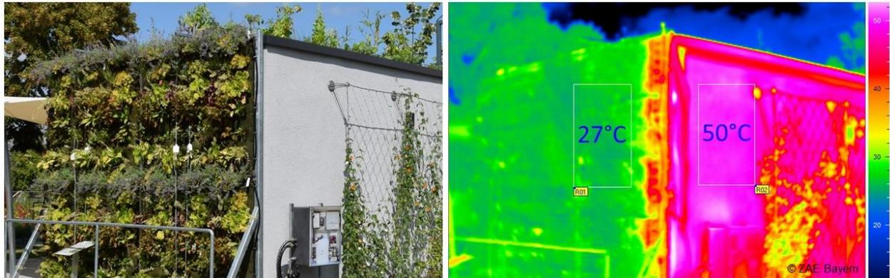
*Abb. 1: Thermografieaufnahme (rechts) am Südhaus der Klimaforschungsstation, ZAE Bayern in Würzburg. @ZAE Bayern*
