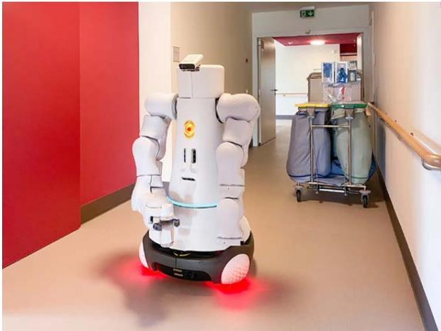
**Der mobile Serviceroboter »Care-O-bot® 4« wurde im Forschungsprojekt S<sup>3</sup> mit neuen Armen und Sensorik sowie verbesserten Erkennungsalgorithmen für den sicheren Einsatz in öffentlichen Umgebungen, wie z. B. Pflegeheimen, ausgestattet.**
