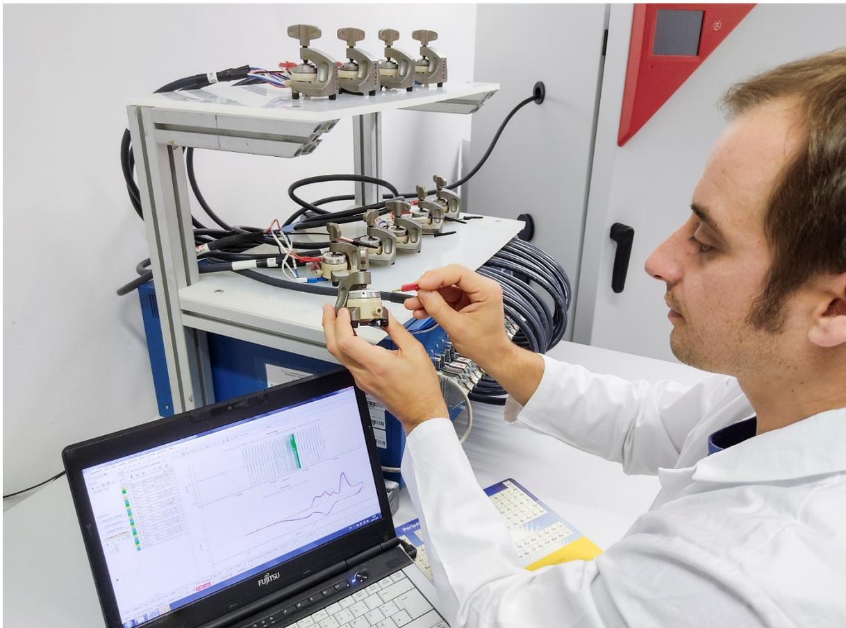
*Kontaktierung von Laborzellen für die Untersuchung der elektrochemischen Leistungsfähigkeit von Aluminium-Ionen-Batterien (AIB) am Fraunhofer-Technologiezentrum Hochleistungsmaterialien THM in Freiberg. © Ulrike Wunderwald / Fraunhofer IISB*
