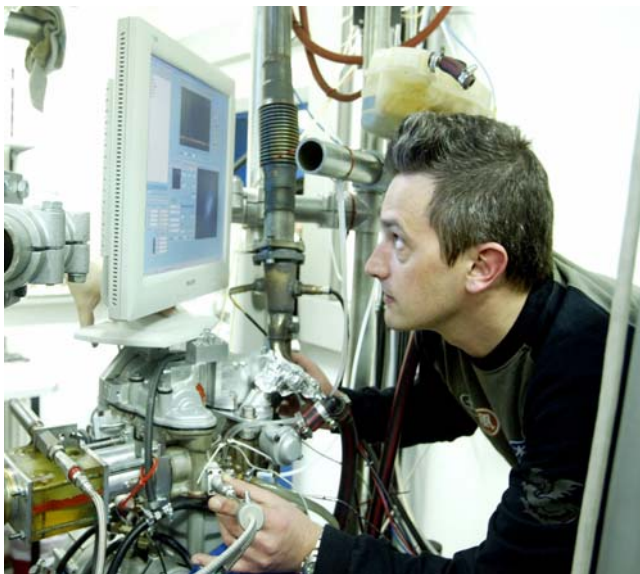
Verbrennungsanalyse am Einzylindermotor mit faseroptischer Endoskopie. (Foto: IFKM)
