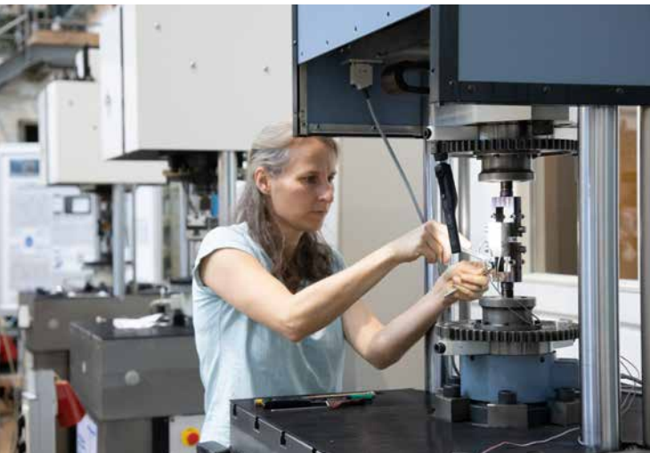
Die Schwingprüfmaschine erzeugt in Materialproben künstliche Risse.
