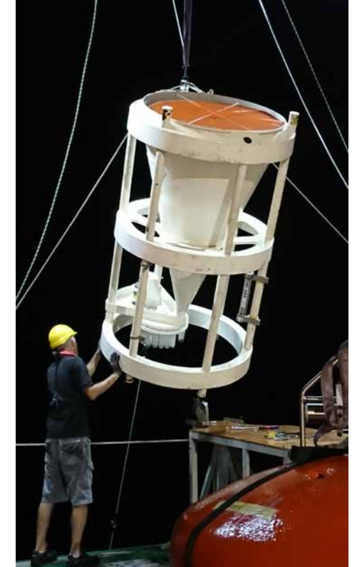
Die Sinkstoff-Falle fängt Planktonpartikel in verschiedenen Wassertiefen ein.
