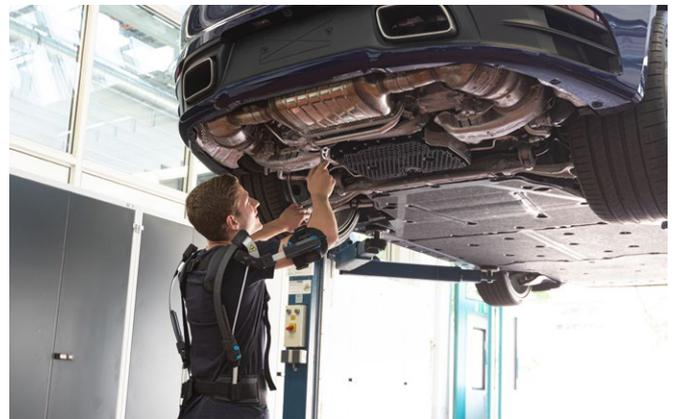
**Zwei Anwendungsfälle für Exoskelette: Das Heben und Tragen schwerer Gegenstände sowie Überkopfarbeiten in der Montage.**
