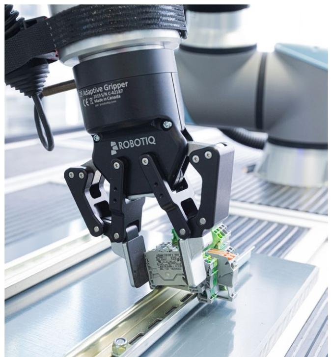
**»Parametrieren statt programmieren« – diese vereinfachte Roboternutzung zum Beispiel für die automatisierte Montage von Reihenklempen mit zahlreichen Varianten ermöglicht die Software pitasc.**
