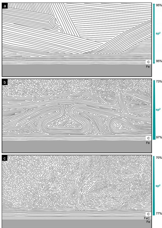
Die Struktur der Graphitschicht vor (a) und nach (b) dem Gleitexperiment und bei hohen Drücken (c).
