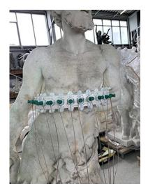
Ultraschall-Tomografie-System mit flexiblem Gurt und mit 32 Wandlern © Fraunhofer IBMT **PRESSEINFORMATION**
