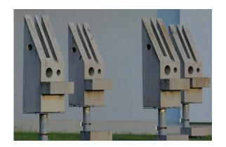
Die Gesteinskörper aus den 1980er Jahren werden regelmäßig vom Fraunhofer IBP u.a. per Ultraschall untersucht.
