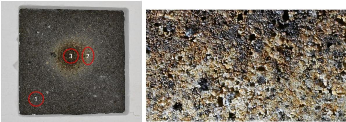
**Abbildung 34:** Links: SoBo-Keramik nach 20 Minuten Bestrahlung mit  $500 \text{ kW/m}^2$ . Der Bereich mit der höchsten Flussdichte (2 und 3) ist verfärbt. Absorptionsspektren an den 3 Stellen sind in Abbildung 35 gezeigt. Rechts: Mikroskopbild der Probenoberfläche nach der Bestrahlung. Im oberen Bildteil ist eine Verdunkelung der Oberfläche gegenüber dem Ausgangszustand sichtbar, während im unteren Teil (mit geringerem Fluss) die Oberfläche heller wurde.
