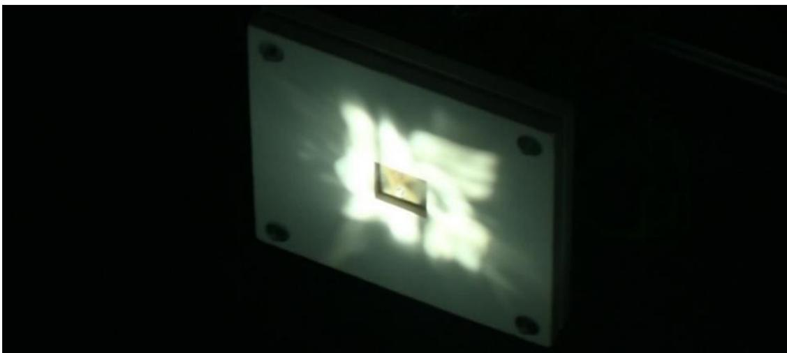
Abbildung 29: SoBo-Keramik im Probenhalter unter konzentrierter Solarstrahlung im Dish-Konzentrator am Fraunhofer ISE (VIS-Foto aufgenommen mit Graufilter).
