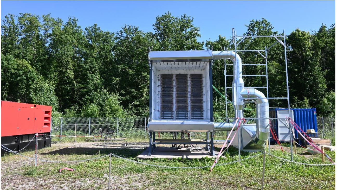
**Abbildung 12:** Der fertig gestellte Messaufbau zum Test einer Luftwand an solarthermischen Strahlungsempfängern am Außentestgelände des Fraunhofer ISE. Auf dem Bild sind ein 500 kW Stromerzeuger (links, rot), zentral der Messaufbau mit Heizelementen und Luftwand-Düsen, rechts daneben der Druckluft-Ventilator und ganz rechts ein Container (blau) für Regelung und Messtechnik zu sehen.
