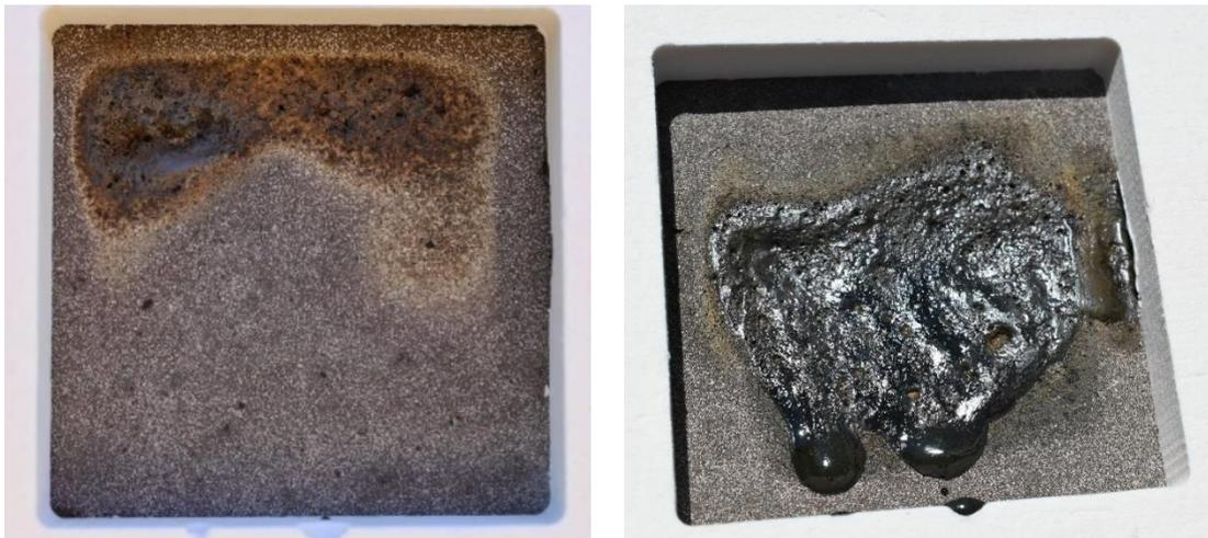
Abbildung 31: Oberfläche der SoBo-Keramik nach 3 Minuten Bestrahlung mit ca.  $0,8 \text{ MW/m}^2$  (links) und nach 20 s Bestrahlung mit ca.  $1,2 \text{ MW/m}^2$  (rechts) im Dish-Konzentrator am Fraunhofer ISE. Beide Bestrahlungsstärken sind über der Belastungsgrenze des Materials und führen zur Schädigung der Oberfläche.
