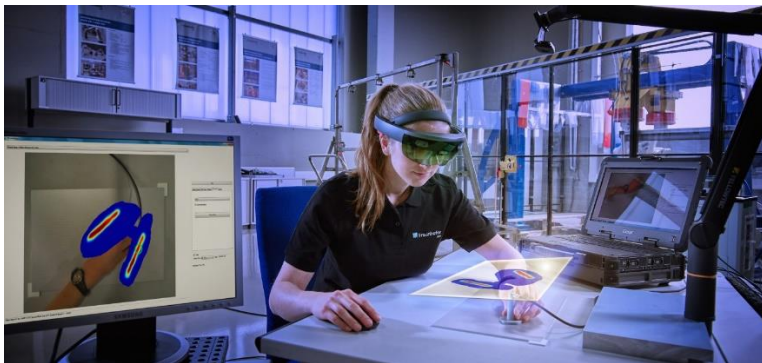
Abb. 2: Augmented Reality-Assistenzsystem zur Unterstützung bei manuellen Prüfungen von Bauteilen oder großen Oberflächen; © Uwe Bellhäuser
