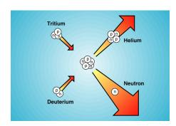
Der favorisierte Brennstoff für eine mögliche Energiegewinnung besteht aus den Wasserstoffisotopen Deuterium und Tritium. Diese Fusionsreaktion besitzt den höchsten Wirkungsquerschnitt. Das radioaktive Tritium muss aber aus den in der Fusionsreaktion entstehenden Neutronen und Lithium erbrütet werden. Der Vorteil ist, dass Tritium in einem geschlossenen Kreislauf erzeugt und gleich wieder verbraucht wird. Bild: MPI für Plasmaphysik
