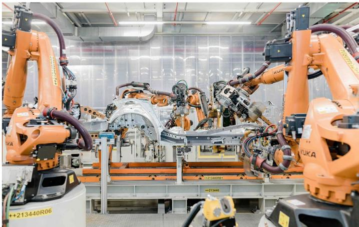
**In einem Projekt mit Audi unterstützten das Fraunhofer IPA und Fraunhofer IAO das Unternehmen bei der Einführung einer sicheren KI-Anwendung für das Schweißen im Karosseriebau.** Quelle: Audi
