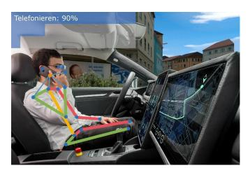
Wie diese Grafik illustriert, erkennt das Advanced Occupant Monitoring System Körperposen sowie bestimmte Objekte und kann daraus auf Aktivitäten der Insassen schließen.
