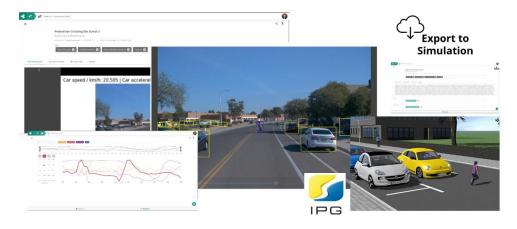
Applikation zur automatischen Identifizierung, Evaluierung und Formalisierung von kritische Verkehrssituationen (Corner Cases) für die Simulation. © EDI GmbH [M]
