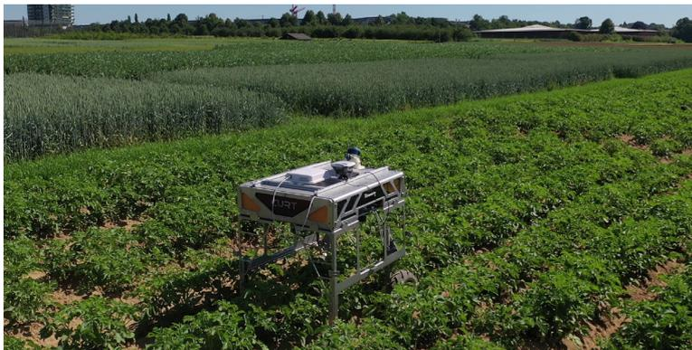
**Der große Roboter CURTdiff kann Pflanzreihen autonom erkennen und abfahren und so perspektivisch z. B. für die Beikrautregulierung eingesetzt werden.**
