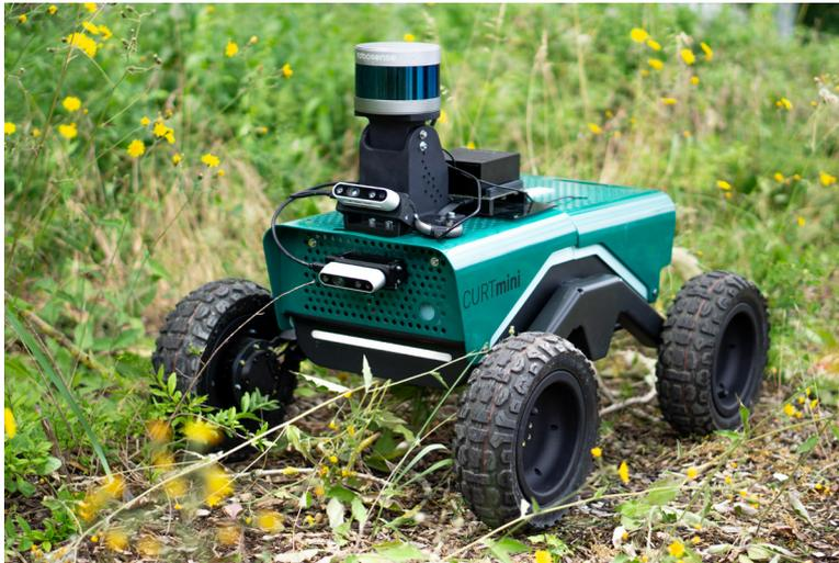
**Der kleine mobile Roboter CURTmini erkennt autonom Untergründe, schätzt diese nach ihrer Befahrbarkeit ein und plant den Pfad entsprechend.**
