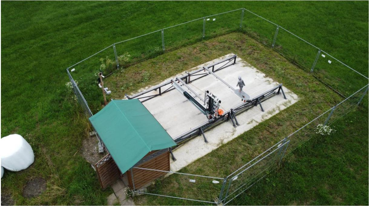
Bildunterschrift: Der Prüfstand in Hagen am Teutoburger Wald. Zwei Jahre lang wurde die Anlage hier Wind und Wetter ausgesetzt, um die Sensoren bei verschiedenen Umweltbedingungen zu testen (Foto: Marvin Strotdresch).
