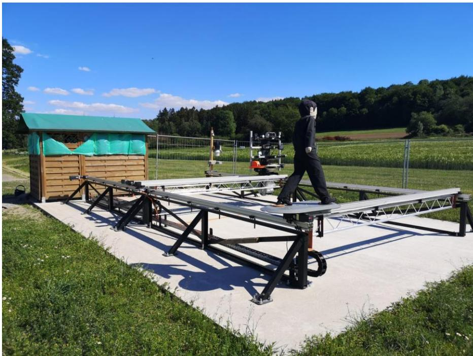
Bildunterschrift: Der Prüfkörper wird über die Anlage gefahren, um zu testen, welche Bereiche die Sensoren erfassen können (Foto: Dr. Christian Meltebrink).
