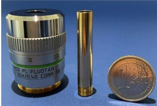
Ein einzelnes ComplexEye-Objektiv (Foto: Mitte) hat einen Durchmesser von 8 mm. Es passt damit genau unter eine Vertiefung (9 mm Durchmesser) einer 96 Well-Platte. Bei einer 384-Well-Platte haben die Vertiefungen einen Durchmesser von 4,5 mm. Damit ist das ComplexEye-Objektiv um ein Vielfaches filigraner und dennoch ähnlich leistungsfähig wie das 28,5-mm-Objektiv (links) eines herkömmlichen Mikroskops. (UDE / Prof. Dr. Matthias Gunzer)
