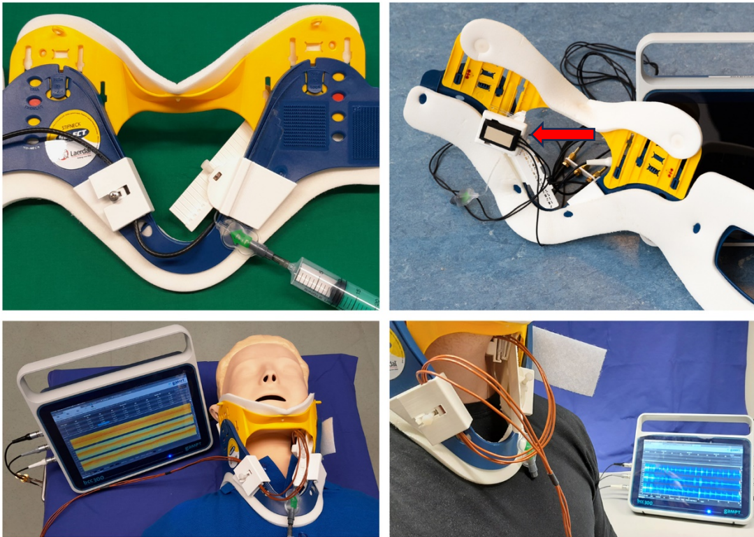
Abb. Links oben: Ansicht von außen. Rechts oben: Ansicht von innen, roter Pfeil zeigt auf den Sensor. Links unten: System am Phantom mit Steuerungseinheit. Rechts unten: System an Mitarbeiter
