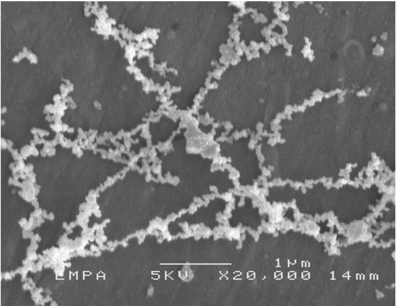
Rasterelektronenmikroskopische Aufnahme von Russ, wie er auf einer weissen Kunststoffabdeckung an der Wohnzimmerdecke einer "schwarzen Wohnung" gefunden wurde. Die Partikel haben eine Grösse von 30-80nm (Nanometer). Vergrösserung: 20'000-fach.
