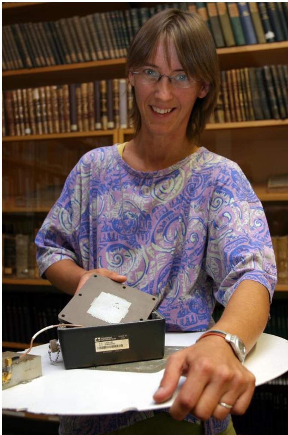
Barbara Görres mit der geöffneten GPS-Antenne. Die helle Metallfläche ist das eigentliche Antennenelement. (c) Frank Luerweg / Uni Bonn
