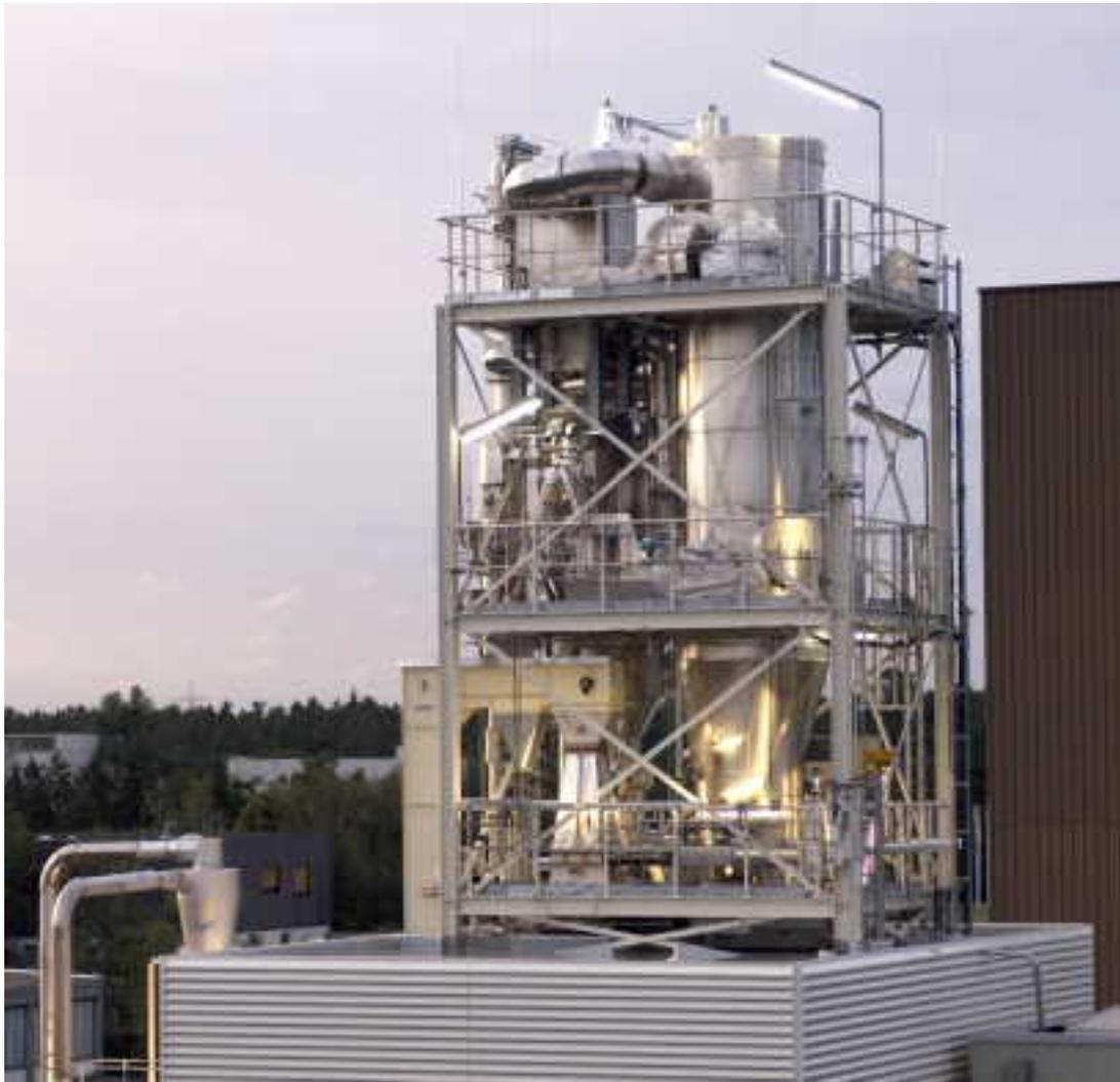
Teil der Schnellpyrolyse-Stufe der bioliq<sup>®</sup>-Anlage zur Herstellung hochwertiger Synthesekraftstoffe im Forschungszentrum Karlsruhe.
