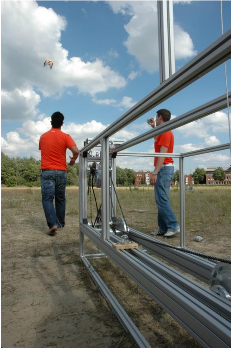
Auf der Wiese hinter dem BIBA: Windkraftanlage mit Bodenstation und Flugdrachen Foto: Sabine Nollmann
