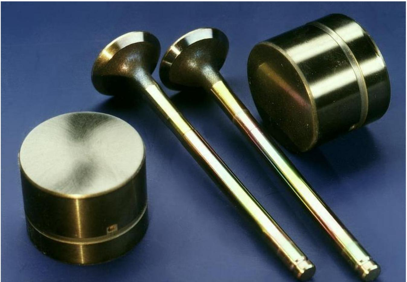
Fraunhofer IST - Mit einer diamantähnlichen Kohlenstoffschicht (DLC) beschichtete Tassenstößel und Ventile helfen, den Kraftstoffverbrauch zu senken.
