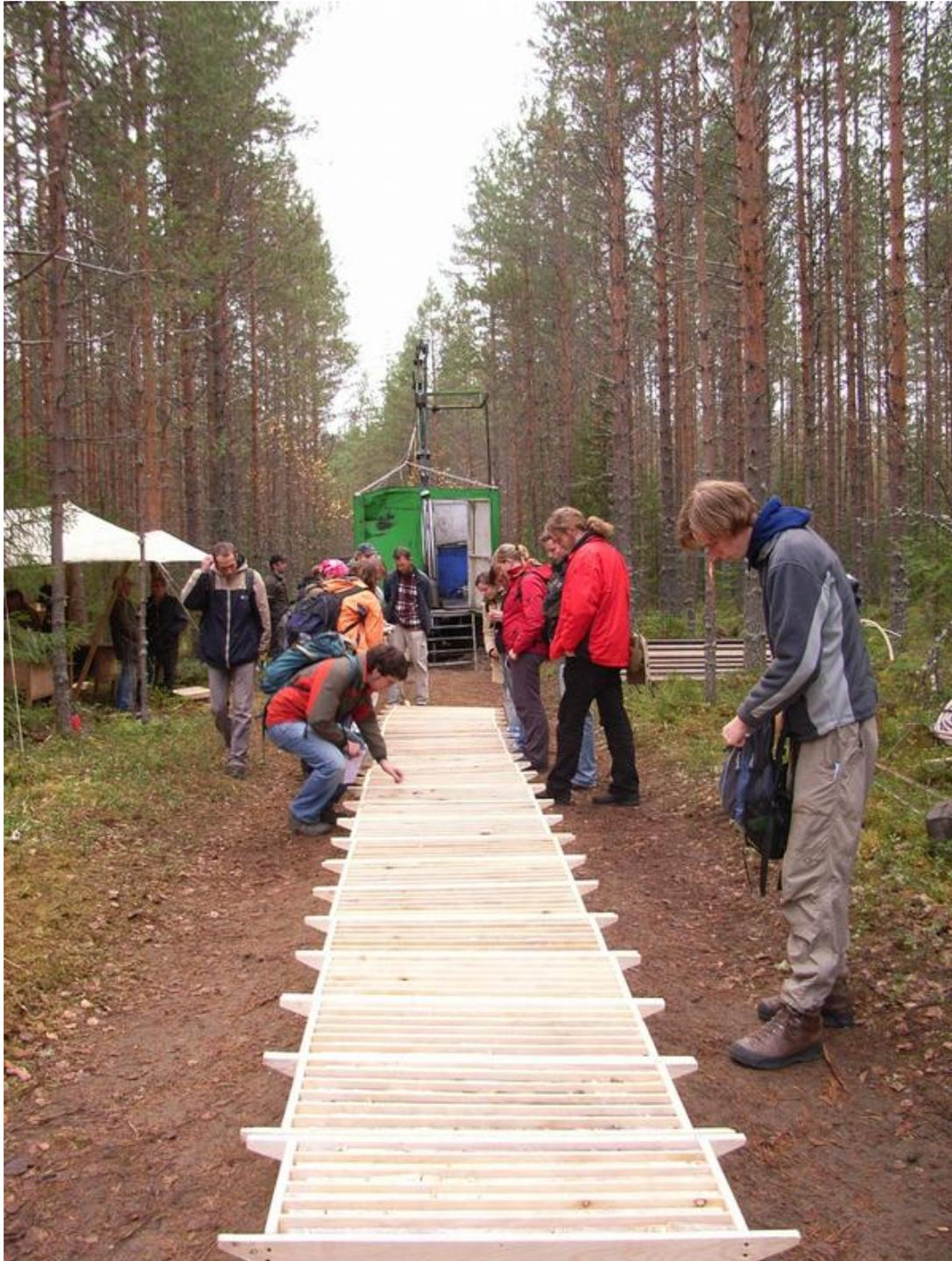
Die münsterschen Studierenden begutachten Stücke des frisch aus der Erde geholten Bohrkerns. In dem Bauwagen im Hintergrund ist das Bohrgestänge montiert.
