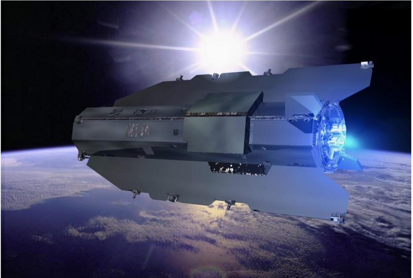
Der Satellit Gravity field and steady-state ocean circulation explorer (GOCE) zur hochpräzisen Vermessung der Erdschwere
