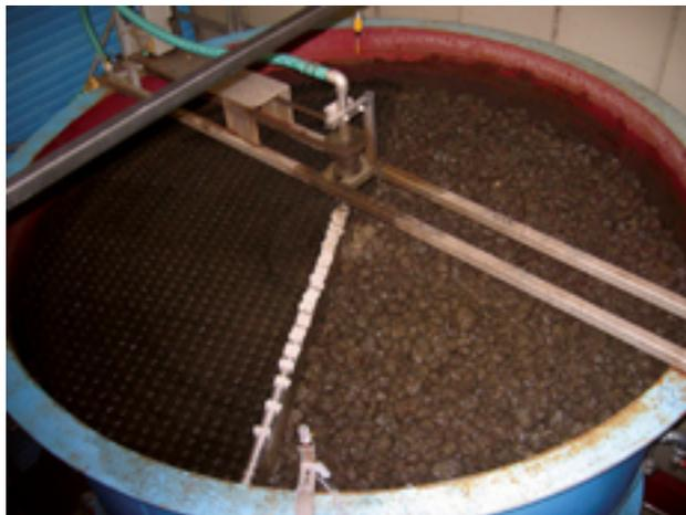
Halbtechnischer Versuchs-Tropfkörper auf dem Lehr- und Forschungsklärwerk der Universität Stuttgart.
