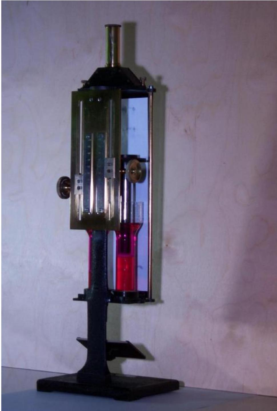
Ein Kolorimeter. Mit diesem Gerät wurde anhand der Färbung einer lichtabsorbierenden Flüssigkeit und der Höhe der Schichtdicke die Konzentration der Substanz in einer Flüssigkeit bestimmt. Weitgehend ersetzt durch Spektralphotometrie.
