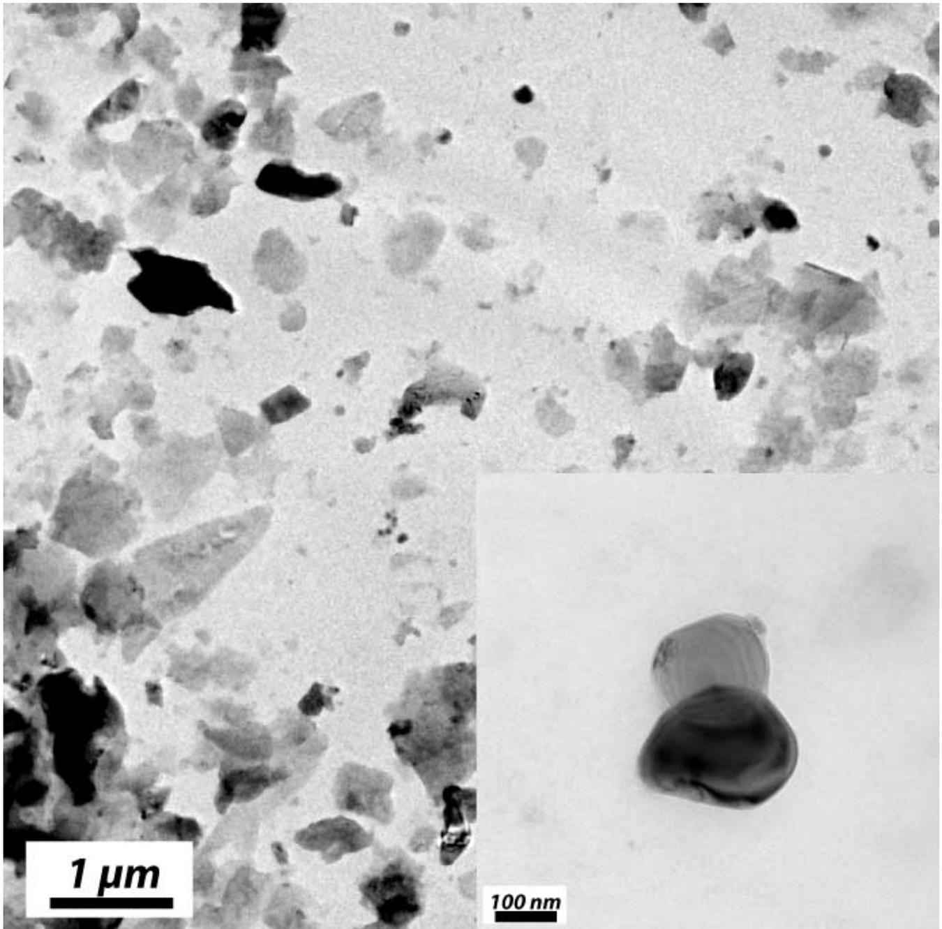
Partikel aus einer Wasserprobe von einem Bach, der durch ein Siedlungsgebiet fließt, aufgenommen mit dem Transmissionselektronenmikroskop. Einzelne Titandioxid-Nanopartikel  $\text{TiO}_2$  (rechts unten) können eindeutig identifiziert werden.
