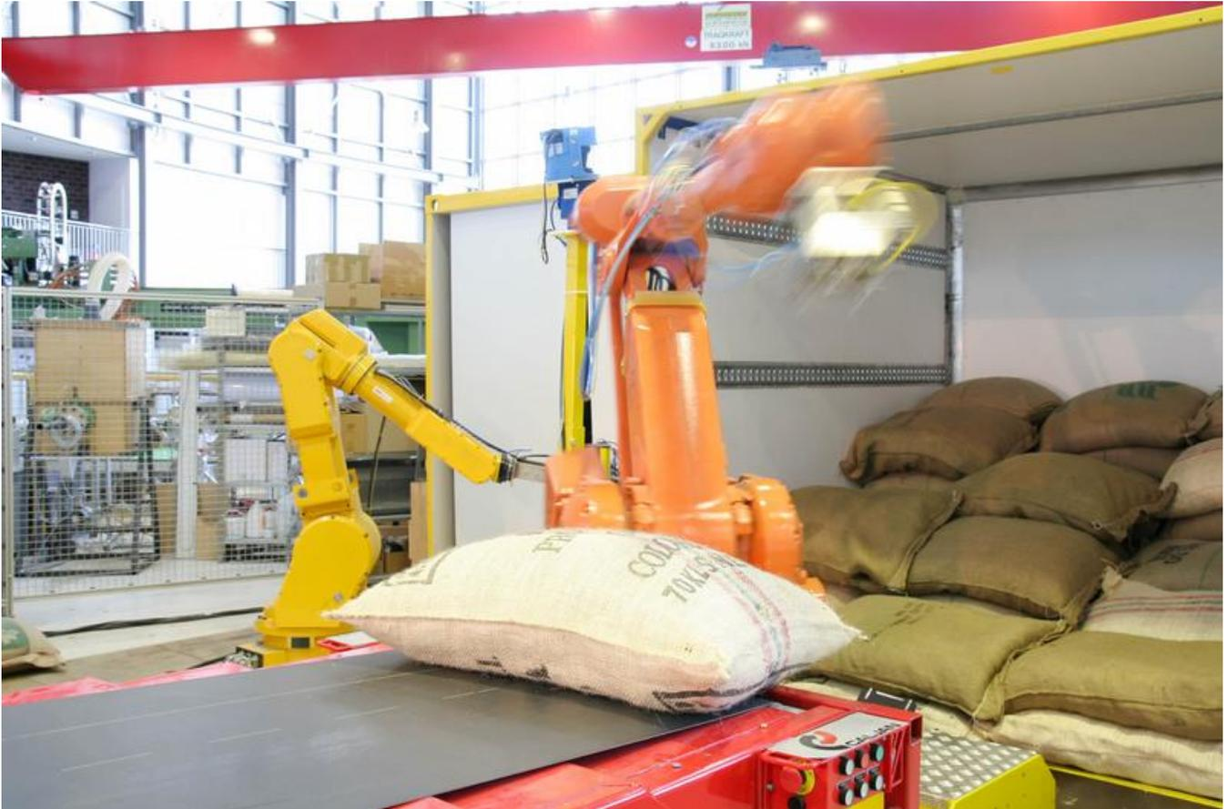
Das Robotersystem kann die Stapelsituation im Container erkennen, die Säcke mit einem speziellen Greifer aufnehmen und sie künftig auch auf einem Förderband ablegen können.
