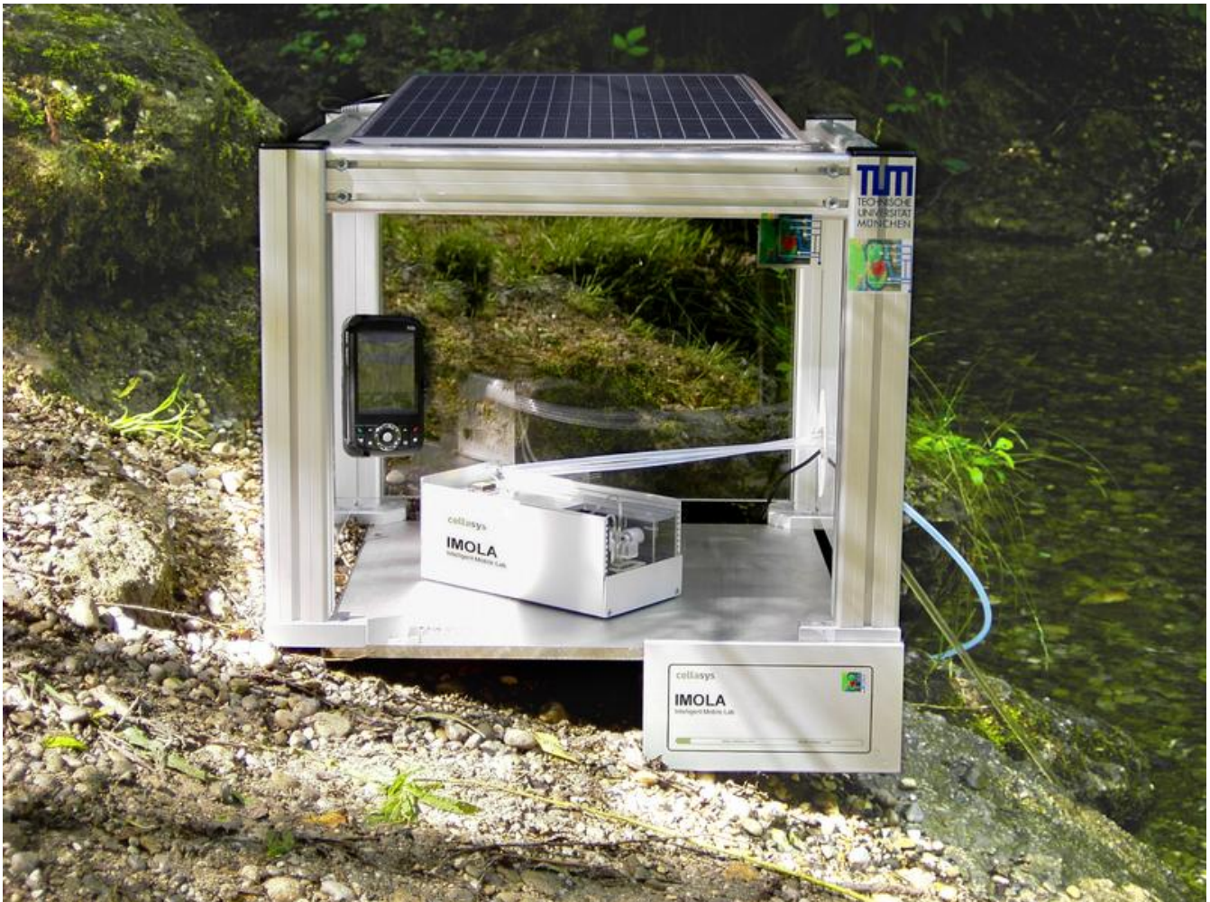
Wasserüberwachungsgerät mit Solarzellen-Energieversorgung und Datenübermittlung über Mobiltelefon Foto: Heinz Nixdorf-Lehrstuhl für Medizinische Elektronik der TU München
