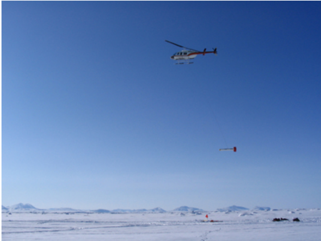
Eisdickenmessung mit EM-Bird (von Helikopter geschleppt) © Lasse Rabenstein, Alfred-Wegener-Institut
