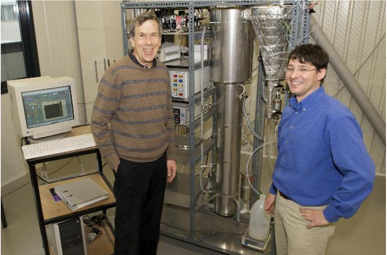
PSI-Forscher Samuel Stucki und Serge Biollaz mit der Laboranlage, an der das Verfahren zur Umwandlung von Holzgas in Methan entwickelt wurde
