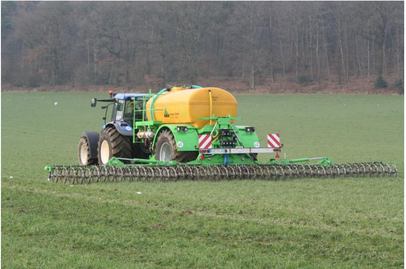
Injektionsdüngung mit Sternrad Lensing-Landmaschinen
