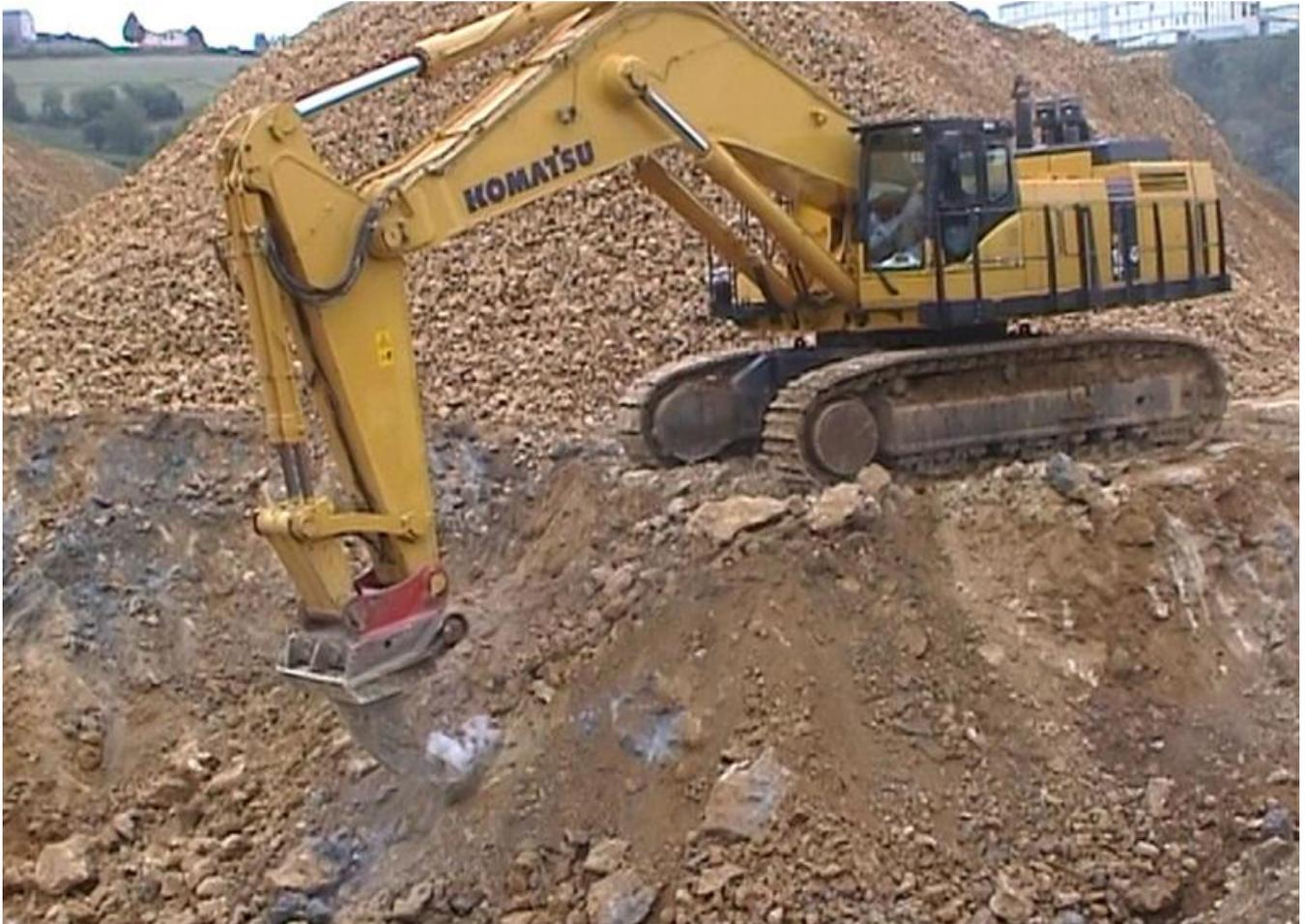
Ein 120 Tonnen Bagger mit einem ca. 1.60 Meter großen Reißzahn bei der mechanischen Gesteinsgewinnung. Der erste Optimierungsansatz für den Bagger-Reißzahn wird auf der Bauma auf dem Stand des Herstellers vorgestellt
