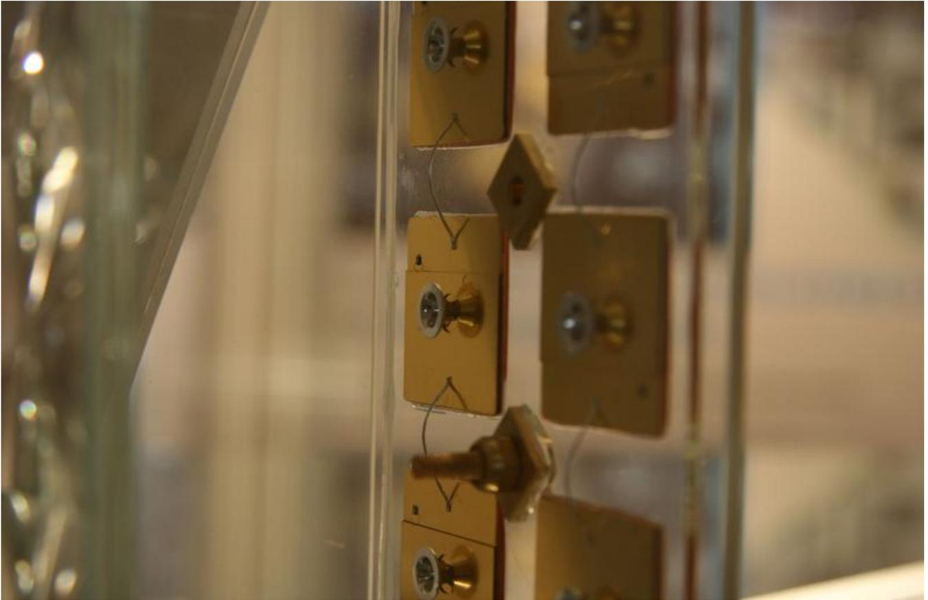
Noch mehr Konzentration: Mit Sekundäroptik arbeitet das Fraunhofer ISE an der Effizienzsteigerung von Photovoltaik-Konzentratormodulen.
