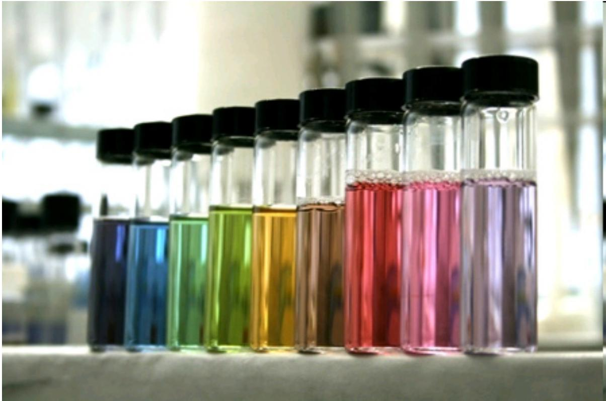
Durch die unterschiedliche Konzentration von Gold-Nanopartikeln ändert sich hier die Farbe der Flüssigkeit.
