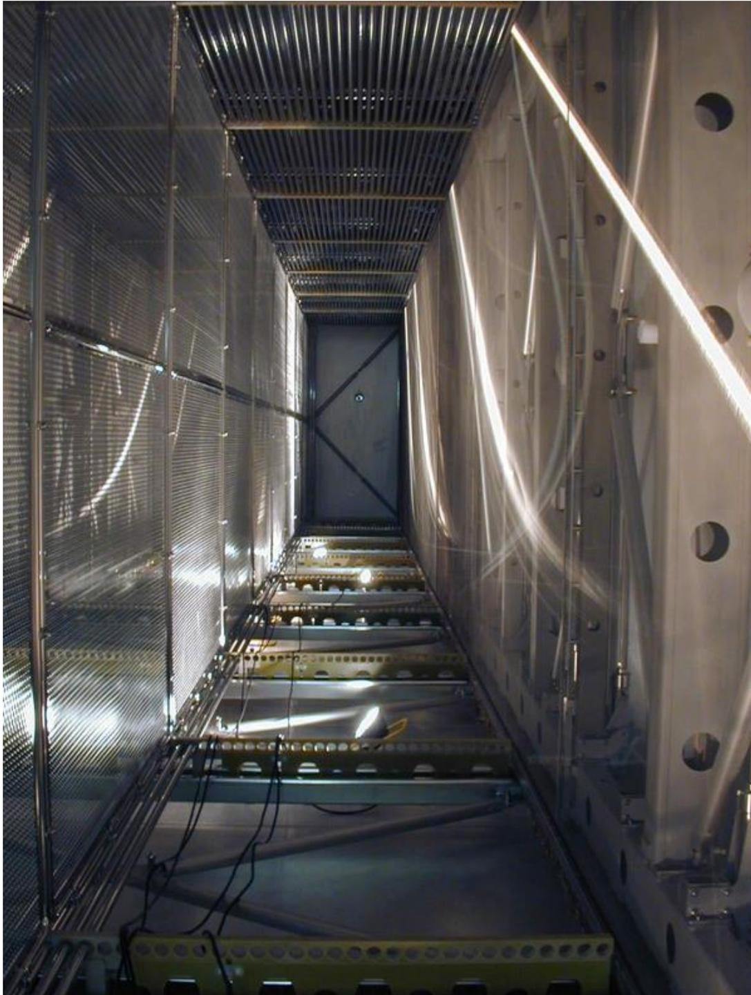
Der komplette Innenteil des Detektors ist extremen Anforderungen ausgesetzt und besteht daher aus einem speziellen Hochleistungswerkstoff, die Nickellegierung Pernifer 36 der ThyssenKrupp VDM. Pernifer 36 zeichnet sich durch besonders geringe thermische Ausdehnung, günstige Verarbeitungseigenschaften und hervorragende mechanische Eigenschaften bei extrem tiefen Temperaturen aus.
